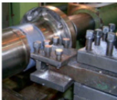
Odbudowa wału pod łożyskiem
