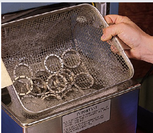
Mycie za pomocą środka o niskim pH Chesterton 820
