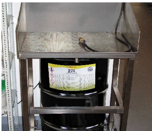
Myjka ze środkiem myjąco-odtłuszczającym 274
